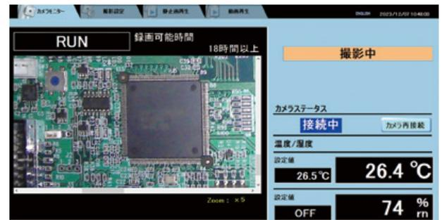
試料観察カメラ(4K)：試料を拡大(x5)して試料を観察
