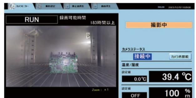
槽内監視カメラ(HD)：槽内全体の試料を監視
